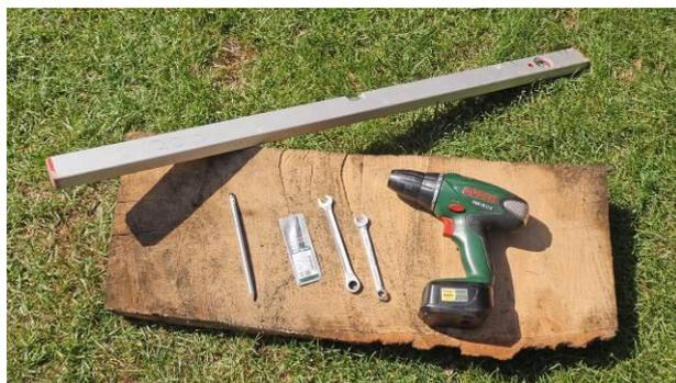
Necesitarás un **taladrador** con una **broca de 4,2 mm** y una de **6 mm**, un **destornillador Phillips (PH2)**. También necesitarás un **nivel de burbuja**, un **flexómetro**, un **lápiz** para marcar y dos **llaves de horquilla nr. 10**. un **taladrador de percusión** con **tornillos** y **tacos** adecuados para su mampostería, una **llave de tubo nr. 10** y una **broca escalonada**.
